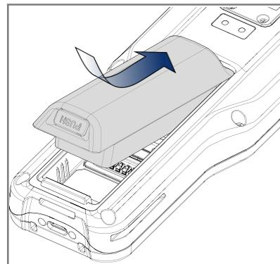
**주의:** 배터리 삽입 전, SIM 카드 및 SD 카드 슬롯 덮개가 완전히 닫혔는지 확인하세요.
