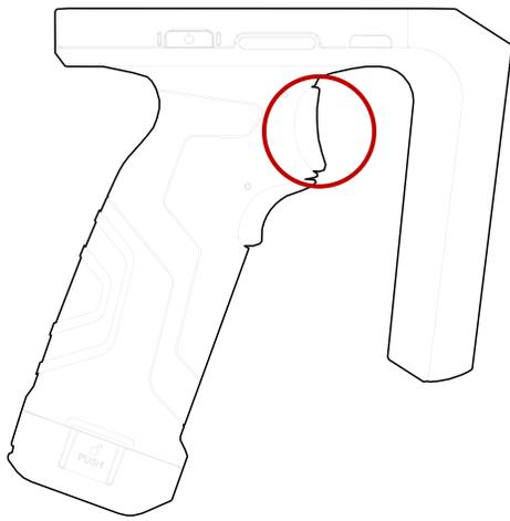
RFID 리더를 호스트 단말과 연결하거나 배치 모드로 설정한 후, 태그가 있는 장소를 겨냥하여 버튼을 누르면 RFID 태그를 읽습니다.
